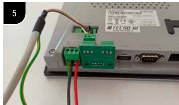
Connessione pannello HCC
