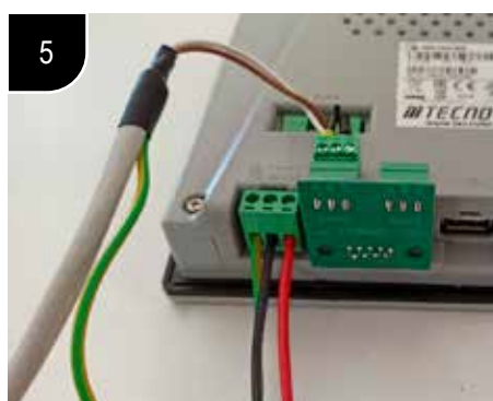
Connessione pannello HCC
