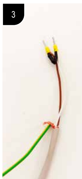
Connessione calza giallo-verde
