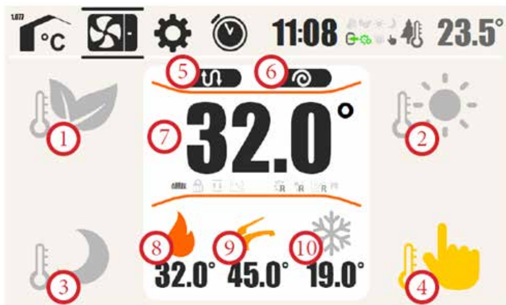
ABB. 87 (Eingestellte Temperaturen Fernbedienung HCC)
