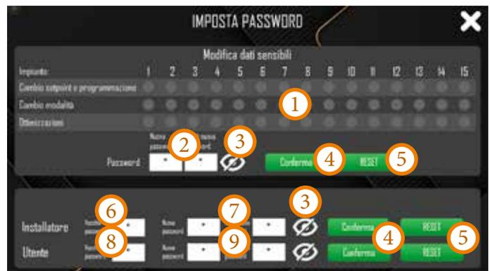
1 In questa tabella sono visualizzate in orizzontale le pompe di calore e in verticale le funzioni che è possibile proteggere da password. Se una pompa di calore non è installata i suoi pallini non saranno visualizzati. Se uno dei pallini della pompa di calore è acceso, allora la rispettiva funzione verrà protetta da password.
