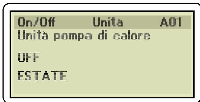
**Maschera A01:** permette di impostare lo stato e la modalità di funzionamento. Lo stato di OFF impostato in questo menù è sempre condizionato (es. intervento antigelo).
