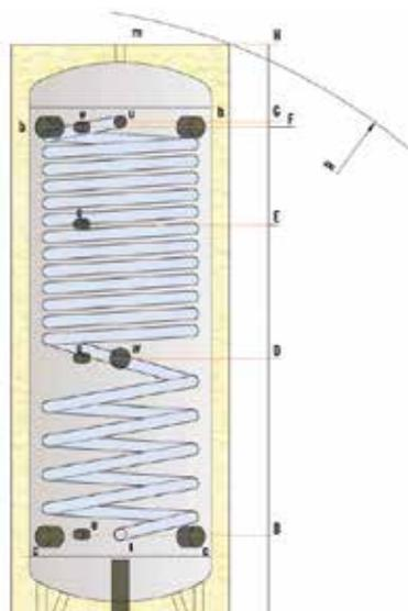
Il termoaccumulatore combinato Smart è un accumulatore di acqua primaria destinato prevalentemente alla produzione istantanea di acqua calda sanitaria (ACS) per mezzo di uno scambiatore di calore corrugato in acciaio inox AISI 316L ad altissima efficienza di scambio. È disponibile nella versione solo accumulo + produzione ACS oppure accumulo + produzione ACS e scambiatore d'integrazione.
